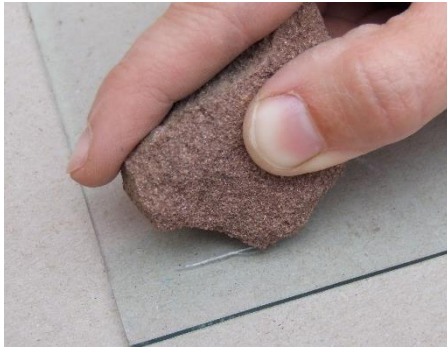
Die Quarzkörner des Sandsteins ritzen Glas.
