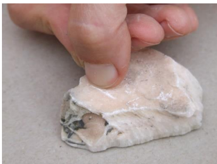
Das Mineral Gips kann man mit dem Fingernagel ritzen.
