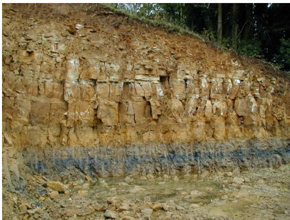
Ein Wechsel geologischer Schichten: Mergel (unten) auf Sandstein (oben) in einer Baugrube im Natur- & Geopark (Photo: SGL).
